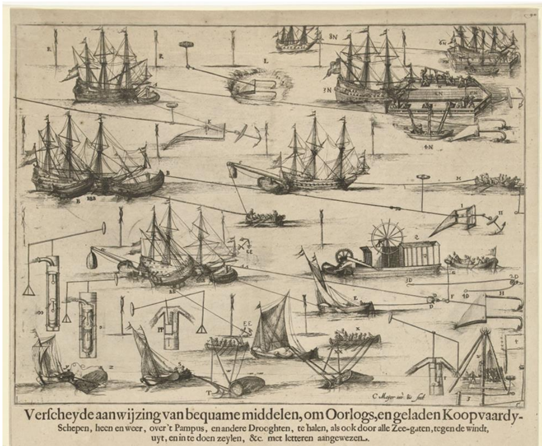
Tekening van constructies om schepen heen en weer over het Pampus te halen, Cornelis Meijer, 1672
